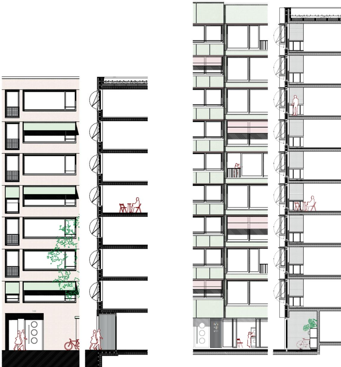
Konstruktionsschnitt und Ausschnitt Fassade 1:200
