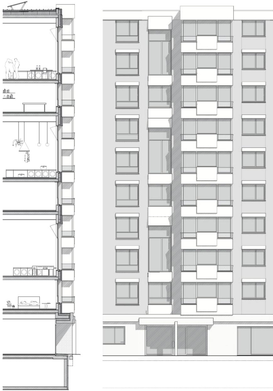
Konstruktionsschnitt und Ausschnitt Fassade 1:200
