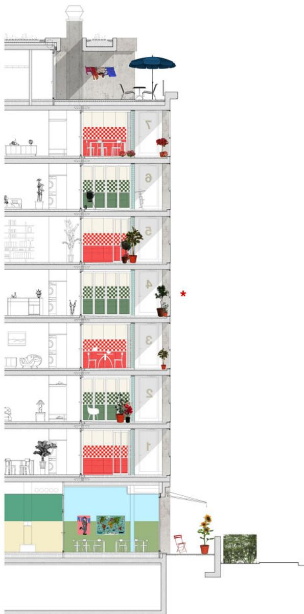
Konstruktionsschnitt und Ausschnitt Fassade 1:200
